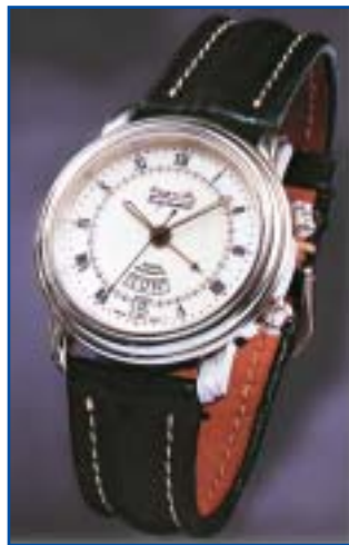
COTTON CLUB 611R050. Редкий механизм AS 5008 с автоподзаводом и будильником. Имеет две отдельные заводные пружины — механизма и будильника, которые автоматически заводятся от движения ротора автоподзавода при носке часов. Серия 99 экземпляров. музей Auguste Raymond, Трамелан
